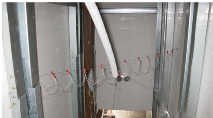
Рис. 3. Расположение системы термодатчиков внутри стены.
