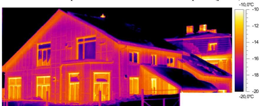
Рис. 2. Характерный вид тепловизионной оценки тепловых потерь [1]
